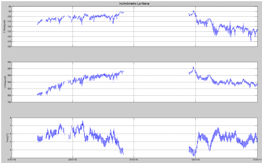
Figura 64. Componentes de inclinación Norte, Este y temperatura del inclinómetro electrónico La Nieve, instalado en el complejo volcánico de Cumbal, para el periodo comprendido entre el 1 de enero y el 31 de diciembre de 2016.
