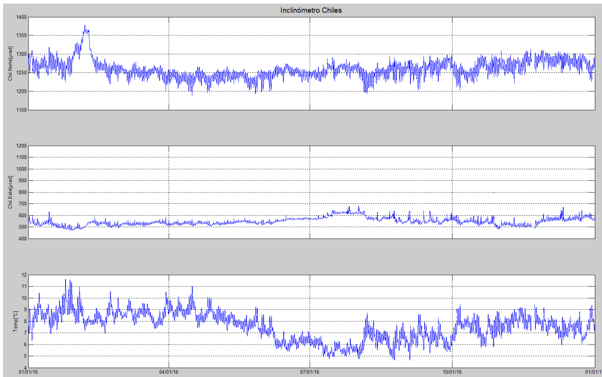
Figura 83. Componentes de inclinación Norte y Este, registro de temperatura del inclinómetro electrónico Chiles, instalado en el volcán del mismo nombre, para el periodo comprendido entre el 1 de enero y el 31 de diciembre de 2016.
