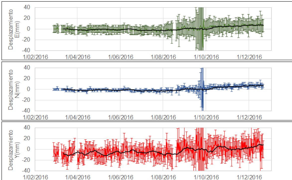
Figura 105. Variaciones en las direcciones Norte, Este y altura de la estación GNSS La Palma instalada sobre la superficie del volcán Doña Juana, para el periodo comprendido entre el 27 de febrero y el 23 de diciembre de 2016.
