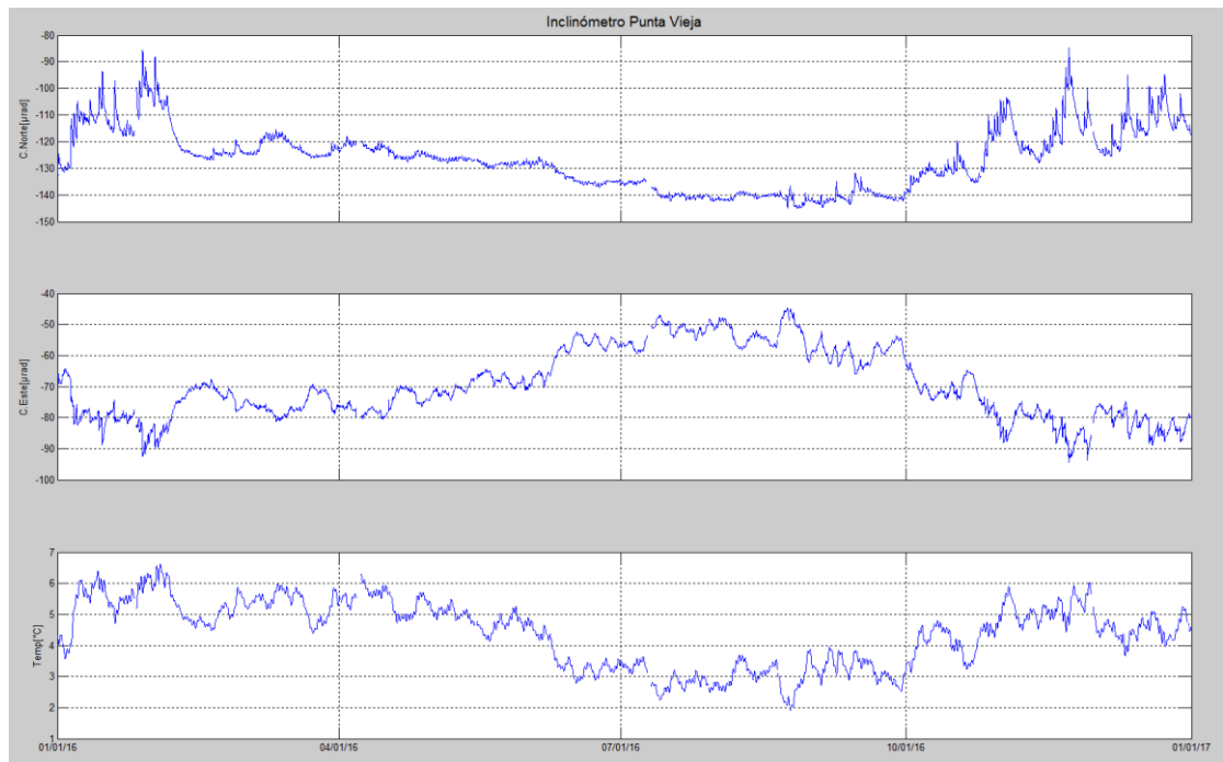
Figura 65. Componentes de inclinación Norte, Este y temperatura del inclinómetro electrónico Punta Vieja, instalado en el complejo volcánico de Cumbal, para el periodo comprendido entre el 1 de enero y el 31 de diciembre de 2016.
